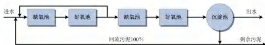
图 3.2.7-6 Bardenpho 工艺流程图
